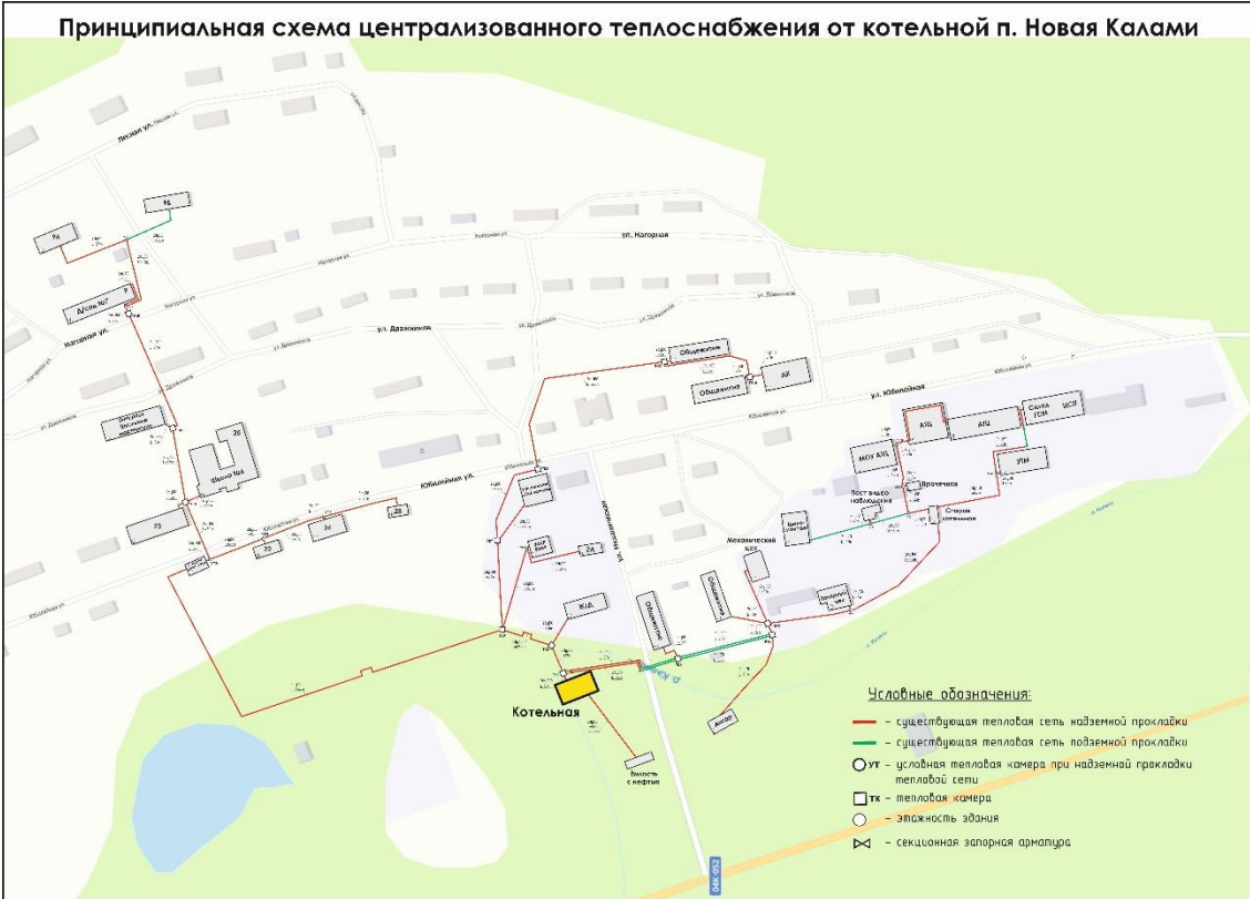
Рисунок 1.1. Существующая зона действия системы теплоснабжения и источника тепловой энергии п. Новая Калами
